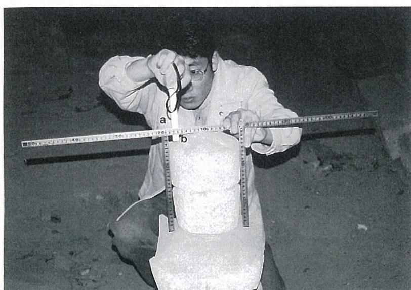
写真 7 空輪頂部の実測
